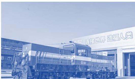
■此次下线的氢燃料混合动力机车采用氢燃料电池系统和大功率锂电池相结合的混合动力方式供电，通过对氢燃料进行氢氧化学反应，直接产生电能驱动机车运行，不仅运行噪声小、成本低、维护便捷，且排出物只有水，完全实现了碳和污染物的零排放。据悉，这台氢燃料混合动力机车设计时速达每小时 80 公里，持续功率 700 千瓦，满载氢气可单机连续运行 24.5 小时，平直道最大牵引载重超过 5000 吨。在不用改变任何铁路基础线路条件下，机车可在各类机务段、车辆段、编组站以及大型工厂、矿山、港口等场所执行运转、调车、救援等多用途的任务。
