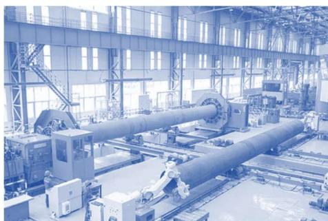
■新能源管材制造项目由中国石油宝鸡石油钢管公司投资，利用中油宝世顺（秦皇岛）钢管有限公司现有生产线进行改造升级，建成了世界首条螺旋、直缝双工艺焊管生产线。项目于 2022 年 9 月 21 日启动设备基础施工。2023 年 6 月 15 日实现国内首根 18 米 JCOE 成型工艺埋弧焊接钢管成功下线（河北省政府网站）。
