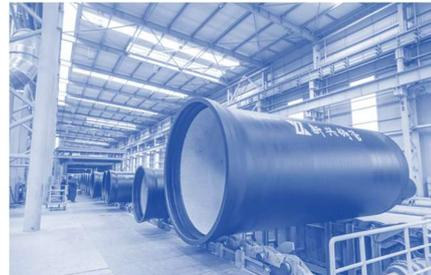
■该球墨铸铁管直径为3米，重量达15吨，相当于10辆家用轿车的重量，是我国重大水利工程基础设施领域的重大技术突破。以常用规格的1米直径管作为对比，该球墨铸铁管的直径增加了2倍，输水量却增加了20倍，产品的材料消耗也节约了19%（国资委网站）。
