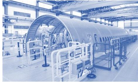
■根据空中客车与中航西安飞机工业集团股份有限公司于 2019 年签署的合作协议,空中客车 A320 机身系统装配项目分为前、后机身两个大部件,分别由空客法国和德国(汉堡)工厂完成机身结构装配后海运到天津,由西飞国际天津公司在机身结构基础上完成相关系统件的安装及测试工作。
